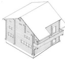
construction en bois plein
