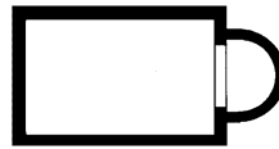
église-salle avec abside (construction en longueur à une nef)
