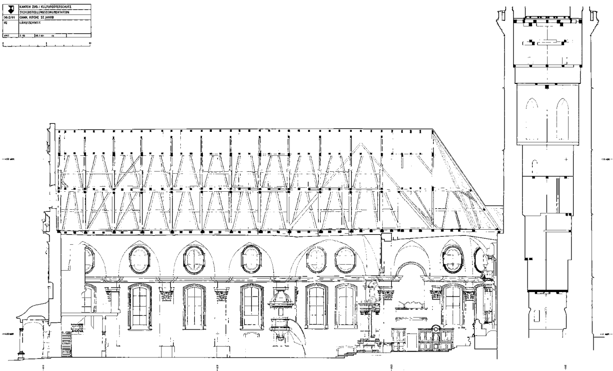
C1 Konstruktionsplan (Längsschnitt); stark verkleinerte Darstellung (Originalmassstab 1:50).
