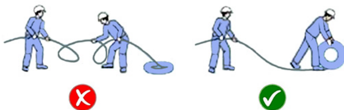
Fig.28: Svolgimento errato e corretto di una fune metallica (Kloska Group)
