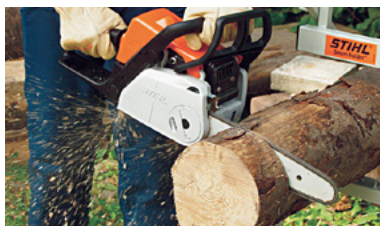
Fig. 12: Guida sicura della motosega, posizione corretta della mano destra e posizione del pollice della mano sinistra e delle gambe (STIHL)
