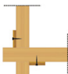
Fig. 66: Fissaggio di una pila di listelli di legno incrociati
