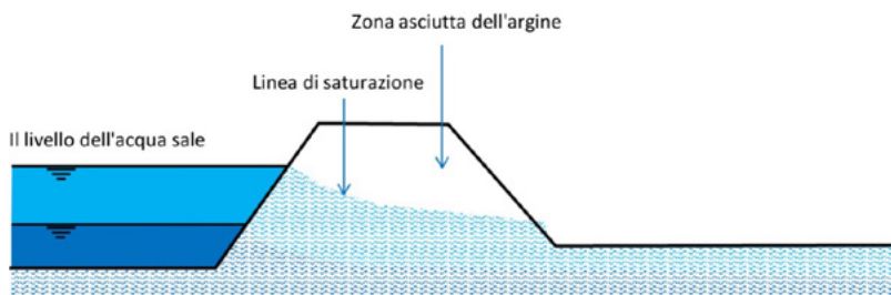
Fig.70: Linea di saturazione in un argine di protezione contro le piene (Bruno Gerber, Ufficio del genio civile del Canton Berna)
