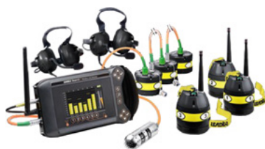
Fig. 39: Esempio di strumento per la captazione di rumori (Leader)
