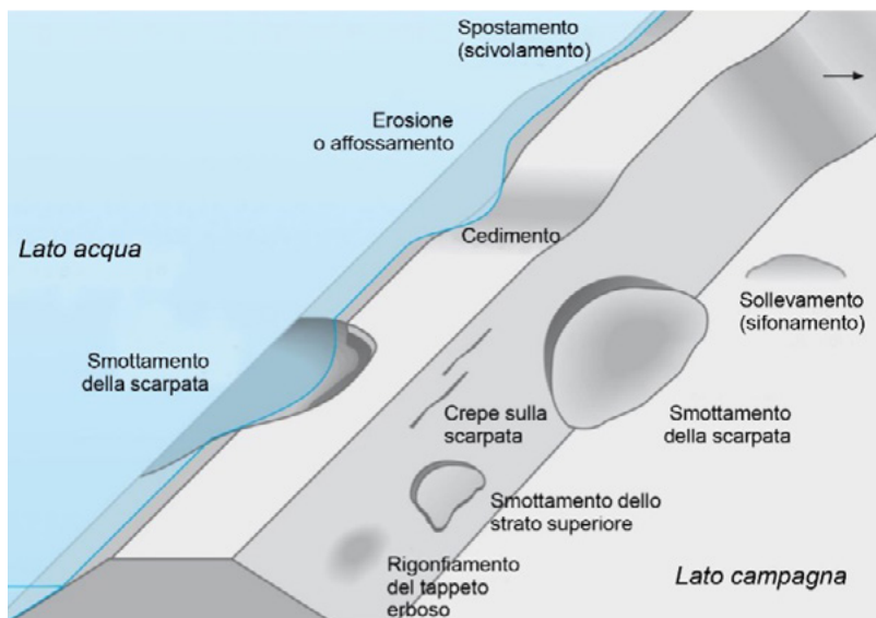
Fig.72: Deformazioni e smottamenti sugli argini (Ufficio bavarese dell'ambiente)
