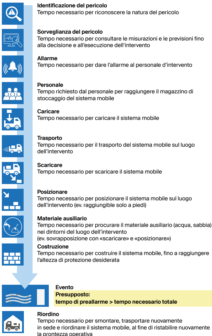
Fig. 6: Esempio di un processo d'intervento, protezione contro le piene (AICAA - Associazione degli istituti cantonali di assicurazione antincendio)
