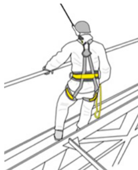
Fig. 25: Arresto caduta (Petzl)
