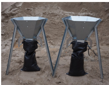
Fig. 34: Tramoggia di riempimento (SAQUICK) (Technisches Hilfwerk – THW)
