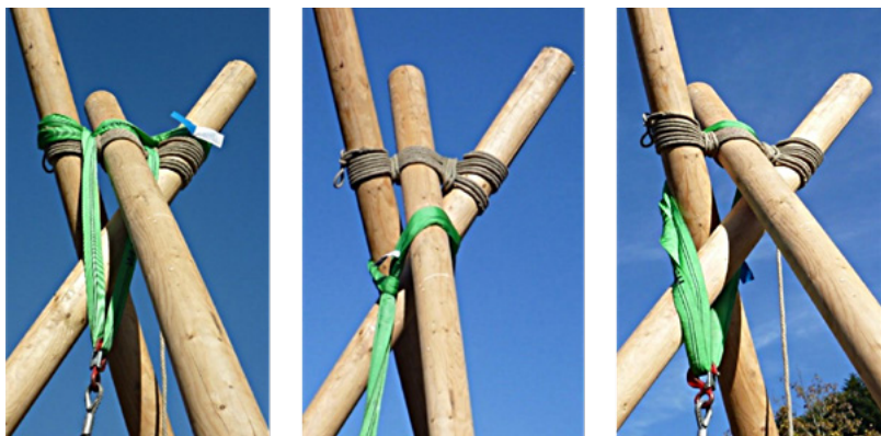
Fig. 48: Possibile modalità di fissaggio della fettuccia al treppiede
