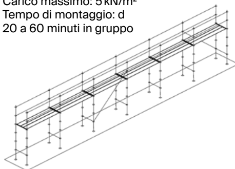
Fig. 93: Schizzo di una passerella per l'acqua alta con elementi di ponteggio EGS (THW)
