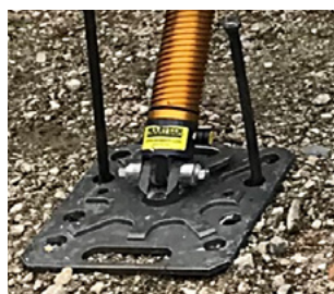
Fig. 86: Puntelli dell'edilizia o del salvataggio con piastra inferiore inclinabile e girevole
