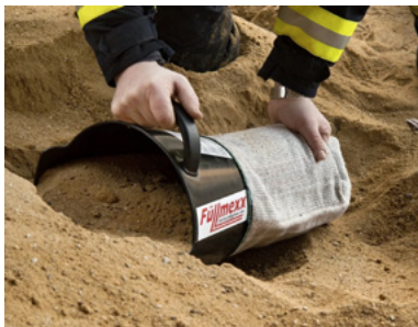
Fig.33: Imbuto manuale (Seidel-Hochwasserschutz.de)
