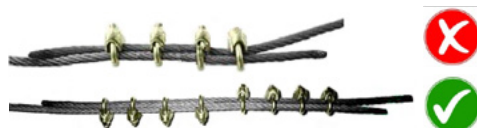
Fig.31: Disposizione errata e corretta dei morsetti per il collegamento di due estremità parallele di funi (BAD Gesundheitsvorsorge und Sicherheitstechnik GmbH)
