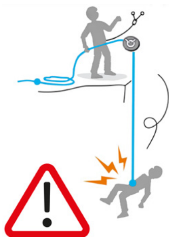
Fig.15: Forza d'arresto in caso di caduta (UFPF)
