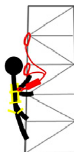
Autoassicurazione con l'assorbitore di energia a Y
