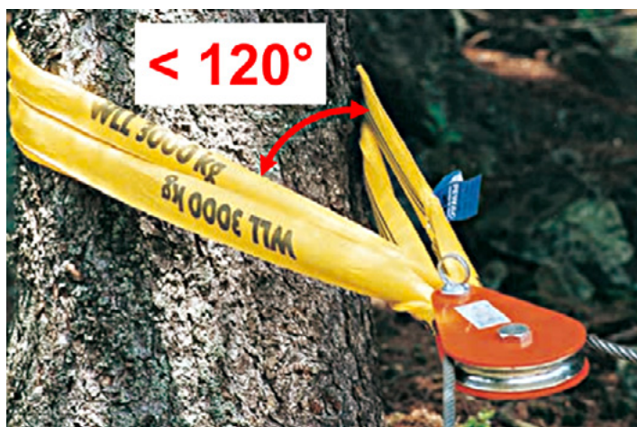
Fig. 23: Angolo d'apertura massimo ammissibile per i mezzi di collegamento
