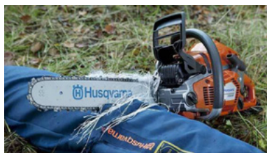
Fig. 3: Catena della motosega a contatto con i pantaloni antitaglio (Husqvarna)
