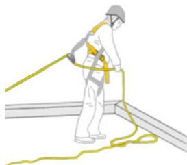
Fig. 21: Sistema di trattenuta (Petzl)
