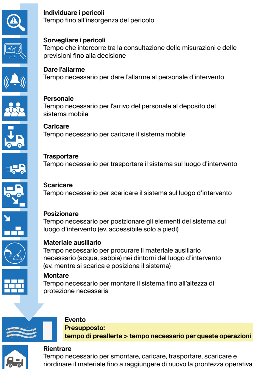
Fig. 24: Processo d'intervento per la protezione contro le piene (Associazione degli istituti cantonali di assicurazione antincendio AICAA)
