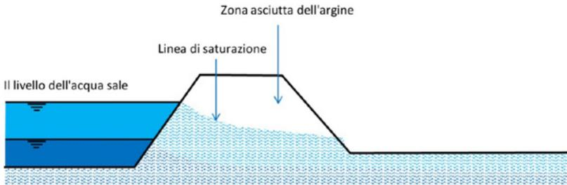
Fig.70: Linea di saturazione in un argine di protezione contro le piene
