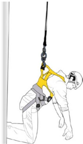
Fig.18: Sospensione inerte a un'imbracatura (Petzl)
