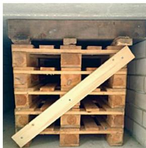
Fig. 71: Esempio di una pila di palette costruita correttamente
