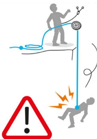
Fig.15: Forza d'arresto in caso di caduta (UFPF)
