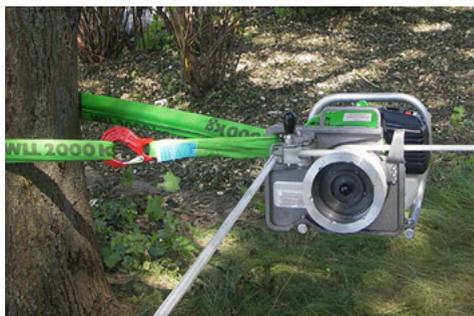
Fig. 30: Fissaggio del verricello (Eder Maschinenbau GmbH)
