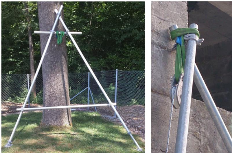
Fig. 52: Esempi di bipiedi con tubi da ponteggio
