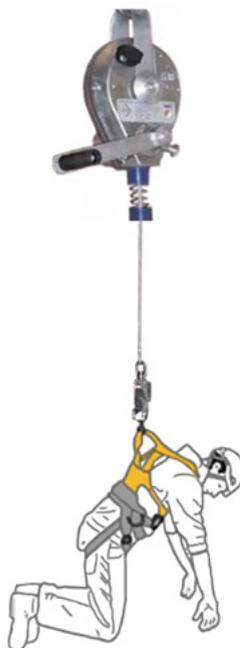
Fig. 28: Salvataggio con un dispositivo anticaduta retrattile (UFPP)
