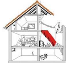
Fig. 50: Superficie inclinata (Technisches Hilfwerk - THW)
