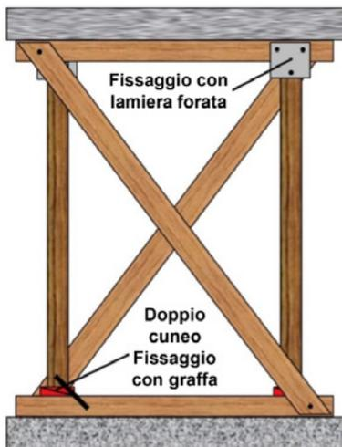
Fig. 51: Costruzione semplice con due puntelli
