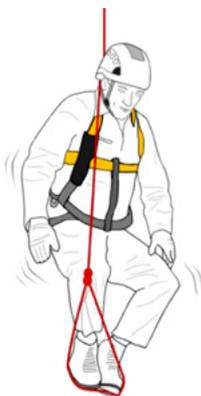
Fig.19: Alleggerire le gambe con l'ausilio di una staffa per i piedi (Petzl)
