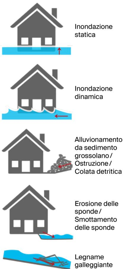
Fig.2: Processi nell'alveo e lungo l'alveo (Bruno Gerber, Ufficio tecnico del Canton Berna).
