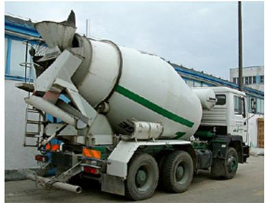
**Fig.37: Autobetoniera (Wikipedia)**
