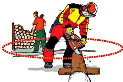
Fig.10: Almeno due metri di distanza di sicurezza (SUVA)
