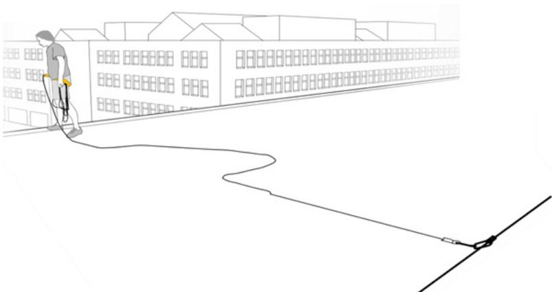
Fig.35: Pericolo di caduta per lasco di corda (Petzl)
