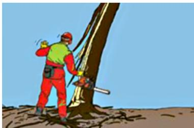
Fig. 15: Tagliare un tronco sotto tensione è pericoloso (SUVA)
