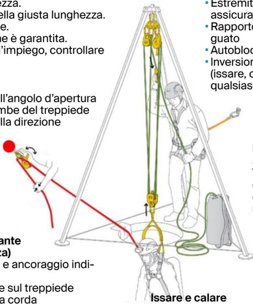
Fig. 66: Regole generali per il salvataggio con corde mediante il treppiede
