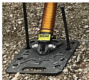
**Fig. 86:** Puntelli dell'edilizia o del salvataggio con piastra inferiore inclinabile e girevole
