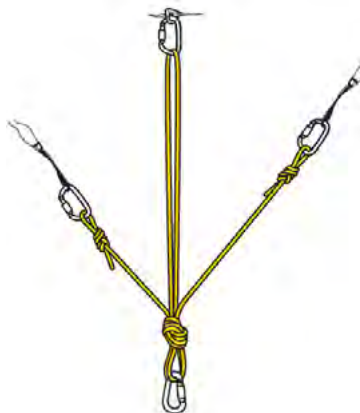
Fig. 55: Ancoraggio a tre punti (Petzl)
