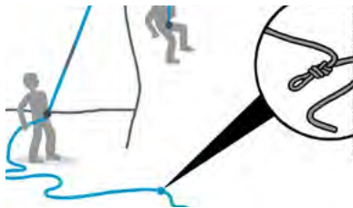
Fig. 37: Entrambe le estremità della corda devono essere assicurate (Petzl)
