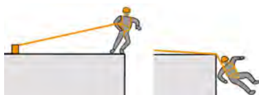
Fig. 23: Limiti della trattenuta (Petzl)
