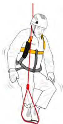
Fig.19: Alleggerire le gambe con l'ausilio di una staffa per i piedi (Petzl)
