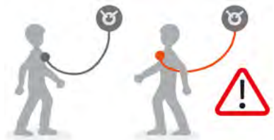
Fig. 38: Posizione corretta del cordino sul corpo (Petzl)
