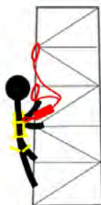
Autoassicurazione con l'assorbitore di energia a Y
