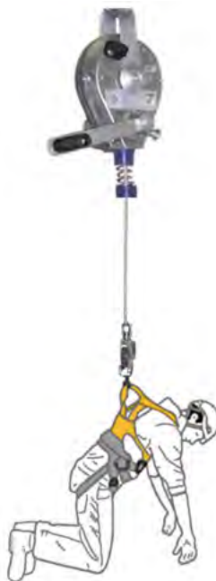
Fig. 28: Salvataggio con un dispositivo anticaduta retrattile (UFPP)
