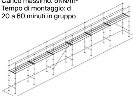
Fig. 93: Schizzo di una passerella per l'acqua alta con elementi di ponteggio EGS (THW)
