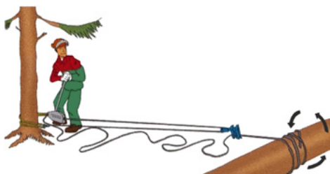
Fig. 27: Girare un tronco abbattuto mediante un paranco con forza raddoppiata (BoscoSvizzero)
