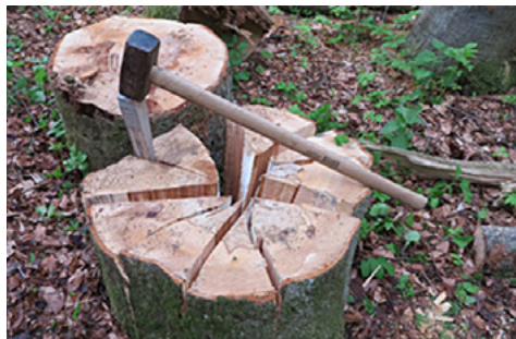
Fig. 35: Spaccare la legna con il cuneo
