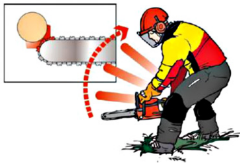
Fig.13: Pericolo di rimbalzo della motosega (SUVA)
