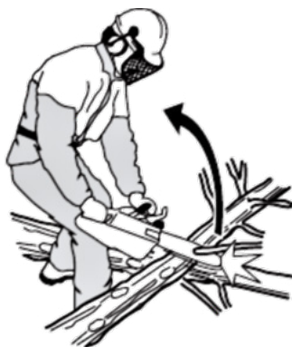
Fig.14: Fare attenzione durante la sramatura (Husqvarna)
