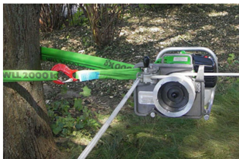
Fig. 30: Fissaggio del verricello (Eder Maschinenbau GmbH)
