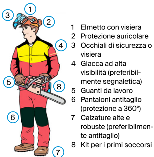
Fig. 2: DPI per lavori con la motosega (SUVA)
