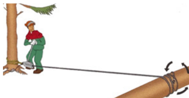
Fig. 26: Girare un tronco abbattuto mediante un paranco con forza semplice (BoscoSvizzero)
