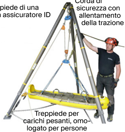
Fig.71: Calare una barella mediante un treppiede per carichi pesanti e un paranco universale (immagine senza dispositivo anticaduta)
