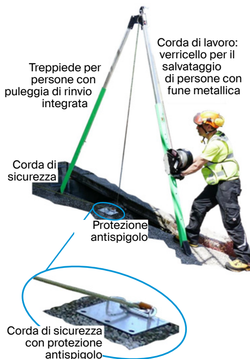
Fig.70: Salvataggio con treppiede e verricello per persone (immagine senza dispositivo anticaduta)
