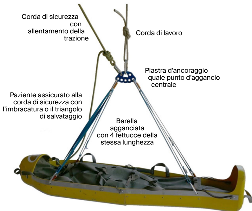
Fig. 68: Aggancio della barella per cunicoli in posizione orizzontale
