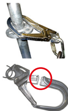
Fig. 51: Ancoraggio a un ponteggio (D-A-CH-S)
