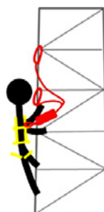
Autoassicurazione con l'assorbitore di energia a Y
