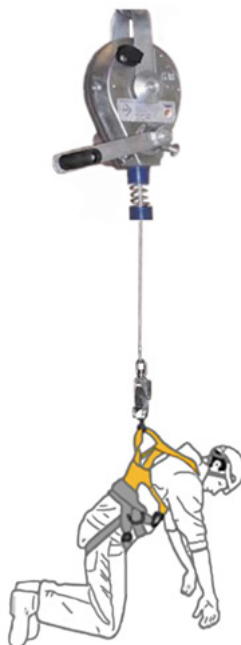
Fig. 28: Salvataggio con un dispositivo anticaduta retrattile (UFPP)
