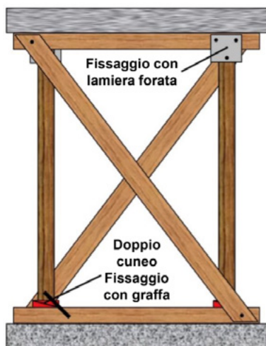
Fig. 51: Costruzione semplice con due puntelli
