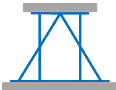
Fig. 53: Rinforzo di un puntellamento verticale bidimensionale con una controventatura ad A
