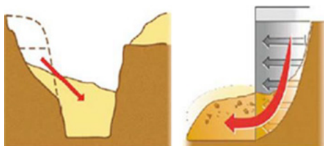
Fig. 80: Pericolo di crollo di trincee e scavi
