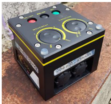
Fig.19: Rilevatore di movimento (OPC Turgovia)
