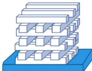
Fig. 61: Pila di listelli di legno incrociati (3 x 3)
