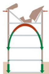
Fig.1: Dissipazione delle forze nella fondazione (Wellenhofer, Technisches Hilfwerk – THW)
