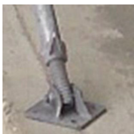
Fig. 86: Puntelli dell'edilizia o del salvataggio con piastra inferiore inclinabile e girevole
