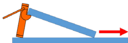
Fig. 61: Forza orizzontale generata dall'attrezzo di sollevamento inclinato
