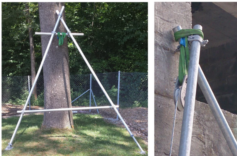
Fig. 52: Esempi di bipiedi con tubi da ponteggio
