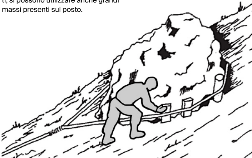
Fig.16: Ancoraggio a un masso (Esercito svizzero)
