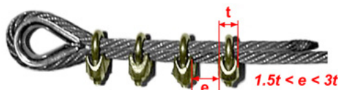
Fig.30: Formula per calcolare la distanza tra i morsetti (BAD Gesundheitsvorsorge und Sicherheitstechnik GmbH).
