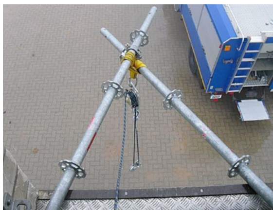
Fig. 57: Esempio di un braccio a delta (Technisches Hilfwerk – THW)
