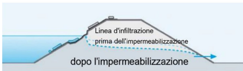
Fig. 80: Argine reso stagno con una pellicola (Ufficio bavarese dell'ambiente)
