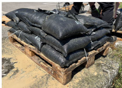
Fig. 52: Disposizione dei sacchi sabbia su di una palette Eu. (THW & UFPP)
