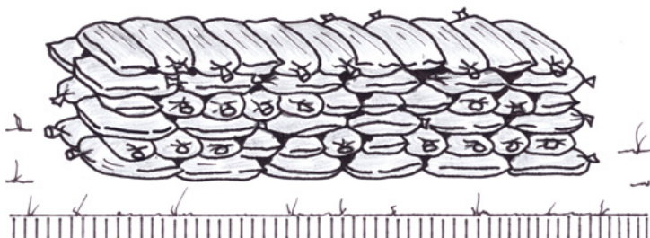
Fig. 51: Pila di sacchi di sabbia alternati (Manuale di costruzione dell'Esercito svizzero)
