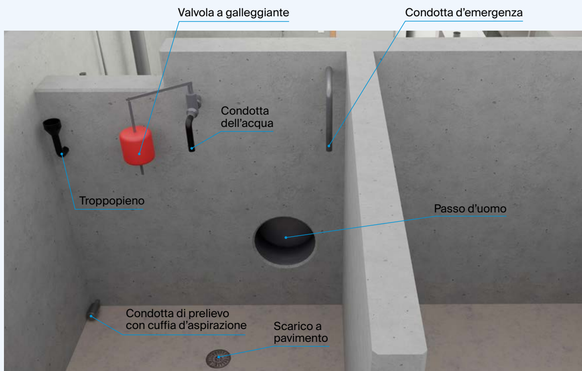
Fig. 3 In caso d'interruzione della rete idrica locale, in cucina l'acqua potabile può essere prelevata dal serbatoio dell'acqua con una pompa manuale.
