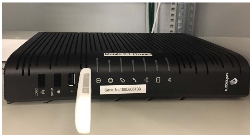
Fig. 8: modem/router SBCON Centro Business 2.0 Swiss con stick USB per 4G LTE
