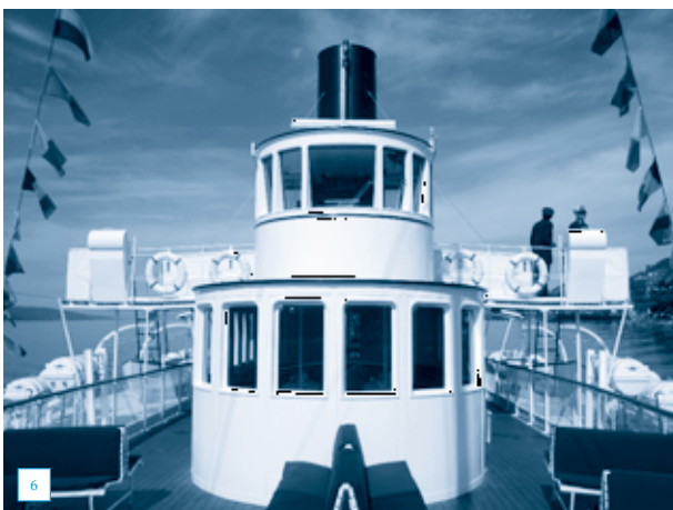
6 Vevey, 1907, en 2013 après rénovation: la grande fenêtre de la timonerie imposée par la réglementation. Photo: © Yves de Siebenthal.
