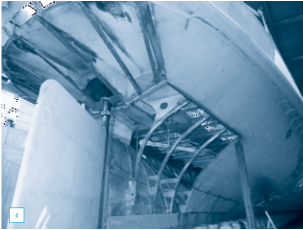
4 Rénovation du Vevey (1907), 2012, remplacement de bordés à la poupe. Photo: © Yves de Siebenthal.
