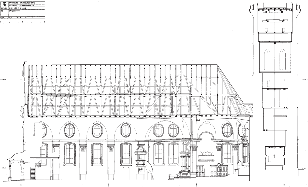
C1 Plan pour la reconstruction (coupe longitudinale); dessin fortement réduit, échelle originale 1:50.
