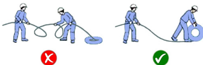
Fig. 28 : Déroulage correct du câble (Kloska Group)
