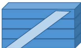
Fig.72 : Pièces de bois équarri empilées les unes sur les autres et sécurisées par un entretoisement diagonal
