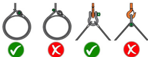
Fig. 27 : Utilisation correcte des manilles (Kloska Group)
