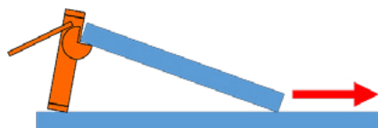
Fig. 61 : Forces horizontales lorsque l'engin de levage est incliné
