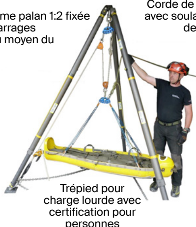
Fig. 71 : Descente en rappel d'un brancard à l'aide d'un trépied robuste et d'un palan universel (Illustration sans sécurité antichute)
