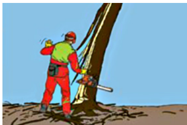
Fig. 15 : Le bois éclaté peut causer des blessures graves (SUVA)
