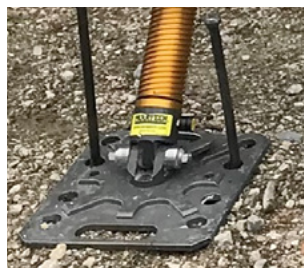
Fig. 86 : Étai avec patins pivotants et rotatifs utilisées dans la construction, pour les échafaudages et les travaux de sauvetage
