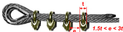
Fig.30 : Formule de calcul de l'écart entre les serre-câbles (BAD Gesundheitsvorsorge und Sicherheitstechnik GmbH)
