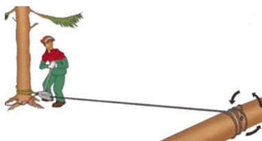
Fig.26 : Retourner un tronc couché de manière directe (ForêtSuisse)
