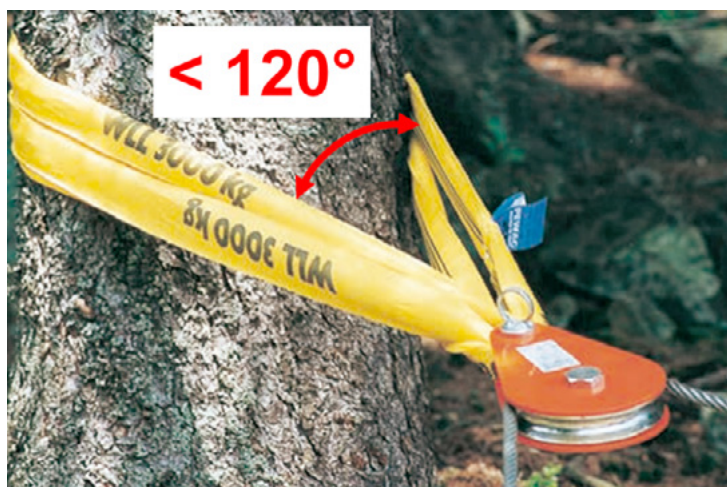
Fig. 23 : Angle d'écartement maximal admis lors de l'utilisation de longes et d'éléments d'attache
