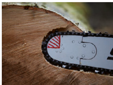
Fig.21 : Étapes pour réaliser une coupe en mortaise – Sozialversicherung für Landwirtschaft, Forsten und Gartenbau (SVLFG)
