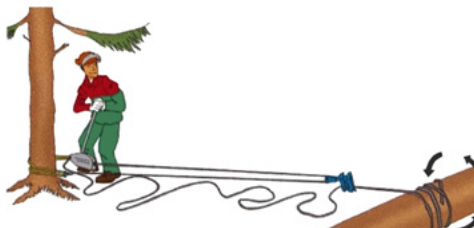
Fig. 27 : Retourner un tronc couché avec un palan Q2 (ForêtSuisse)
