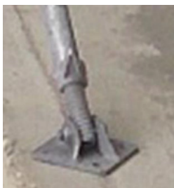
Fig. 86 : Étai avec patins pivotants et rotatifs utilisées dans la construction, pour les échafaudages et les travaux de sauvetage
