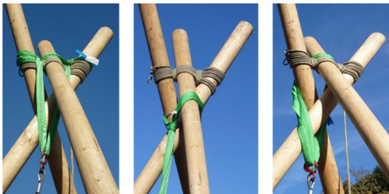
Fig. 48 : Possibilités d'attacher une élingue à un trépied
