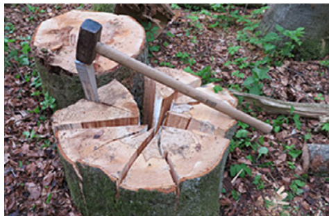
Fig. 35 : Fendre le bois avec un coin de fendage
