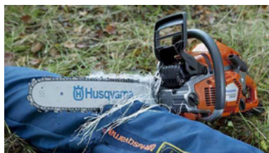
Fig. 3 : Tronçonneuse en contact avec un pantalon anti-coupures (Husqvarna)
