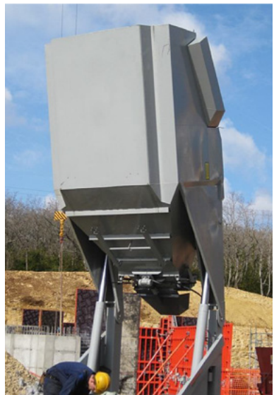
Fig. 38 : Silo de transbordement (BAKO AG)
