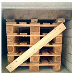
Fig.71 : Exemple d'une pile de palettes correctement disposée (Blockhaus, THW)
