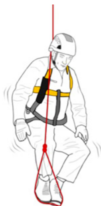
Fig.19 : Délester les jambes à l'aide d'une pédale (Petzl)
