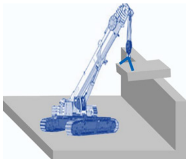
Fig.14 : Sécurisation avec une grue mobile
