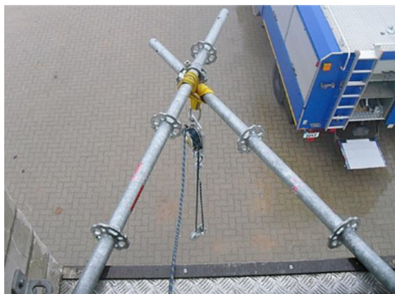
Fig. 57 : Exemple d'un potence triangulaire (THW)
