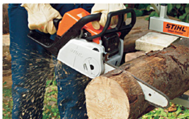
Fig. 12 : Position correcte de la main droite et du pouce de la main gauche ainsi que des jambes pour pouvoir guider la machine en toute sécurité (STIHL)
