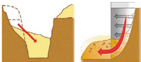
Fig. 80 : Danger d'effondrement des excavations
