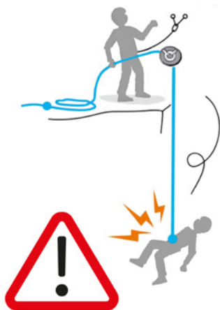
Fig. 15 : Force de choc lors de l'arrêt d'une chute (OFPP)
