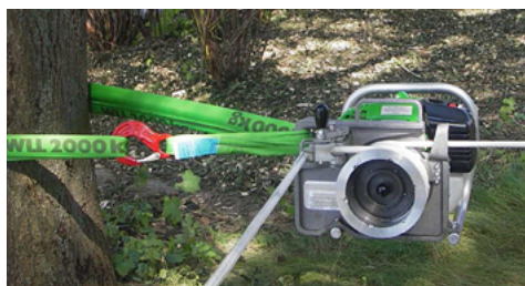
Fig. 30 : Installation du treuil (Eder Maschinenbau GmbH)
