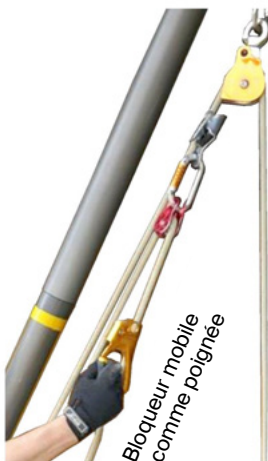
Fig. 72 : Levage d'un brancard au moyen d'un trépied robuste et d'un palan universel (Illustration sans protection antichute)
