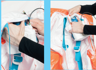
Gebläse wird in Innentasche des Anzuges platziert.
