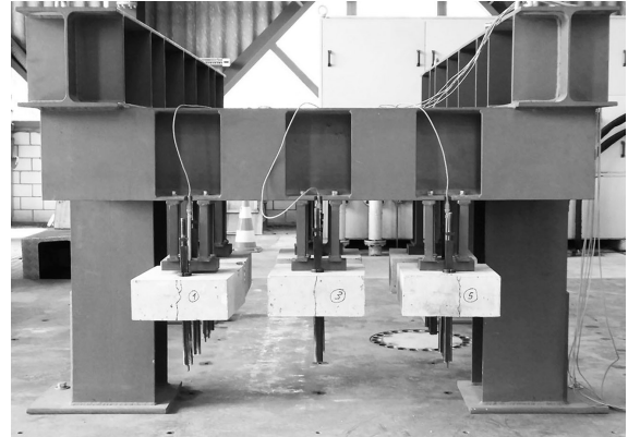
Bild 7: Dübelschockprüfung mit der Vertikalen Schockprüfanlage (VESPA)
