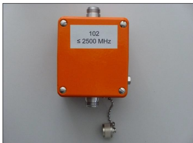
Fig. 9 Boîte de raccordement d'antenne à 2500 MHz, avec parasurtension, douille N
