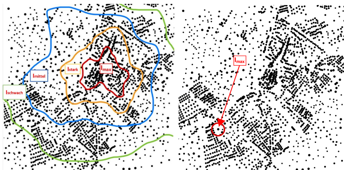
Figure 2-1. Le bâtiment doit pouvoir supporter une réplique qui surviendrait à proximité immédiate, c'est-à-dire qu'il faut considérer la migration possible de la zone d'intensité maximale vers le bâtiment à évaluer (centre cercle rouge). Figure de gauche : les forces enregistrées après le principal tremblement de terre. Figure de droite : déplacement de la zone présentant le niveau d'intensité le plus élevé - une hypothèse à garder à l'esprit lors de la prise en compte d'éventuelles répliques dans le cadre de l'évaluation d'un bâtiment particulier après un séisme. 8
