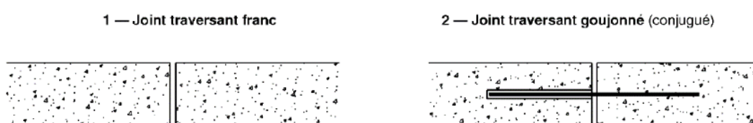
Figure 2-35. Détails d'exécution de joints de dilatation 29
