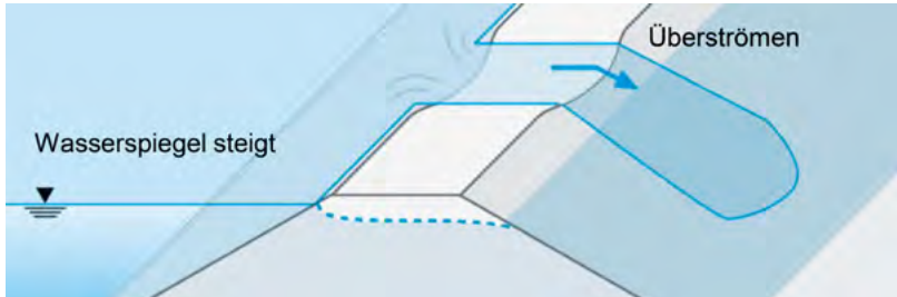
Abb. 73: Überströmung eines Dammes (Bayerisches Landesamt für Umwelt)
