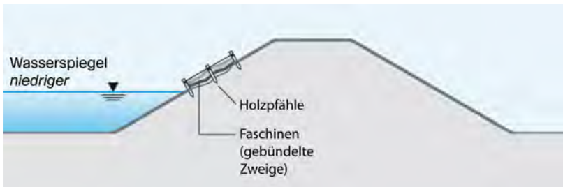
Abb. 78: Einbauen von Faschinen in einen Damm (Bayerisches Landesamt für Umwelt)
