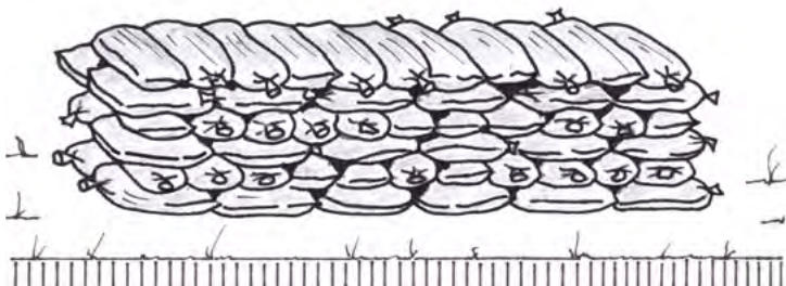
Abb. 51: Stapel versetzter Sandsäcke (Bauhandbuch der Armee)
