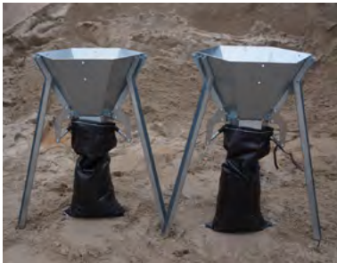
Abb.34: Fülltrichter (SAQUICK) (THW)
