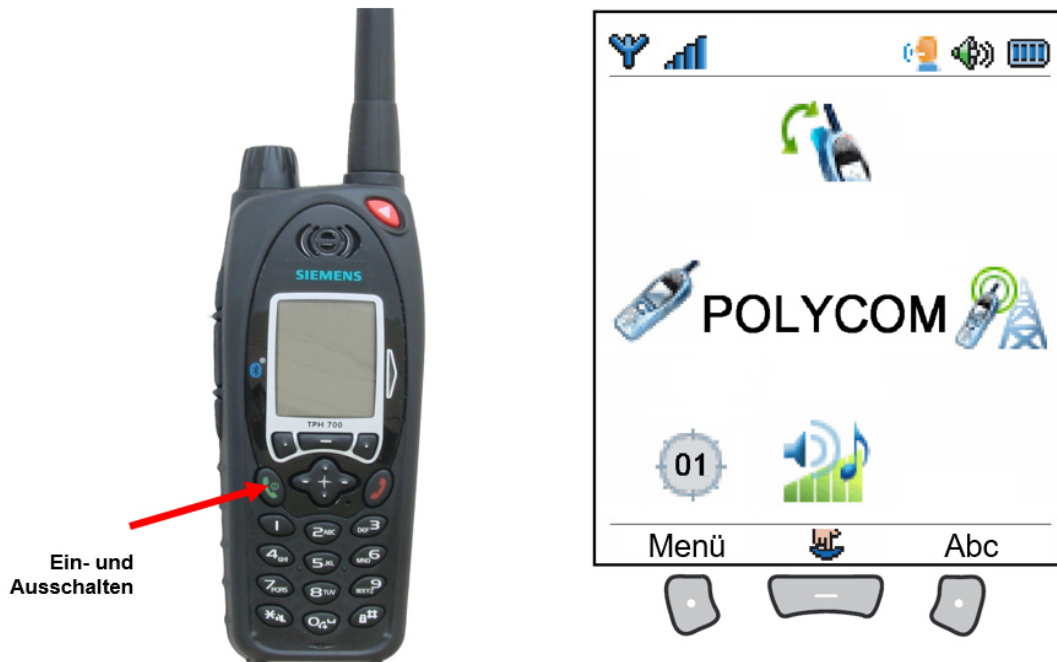
Abb. 11: Grüne Taste für das Ein- und Ausschalten des Funkgerätes
