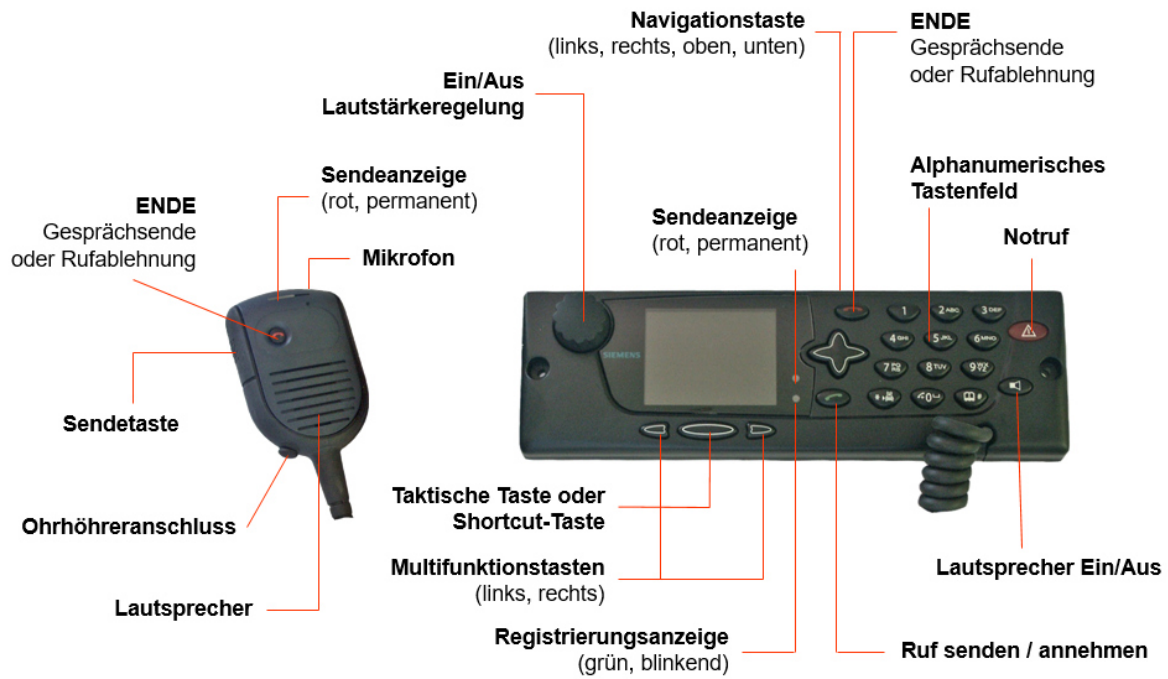
Abb. 17 Geräteaufbau TPM700 Frontansicht
