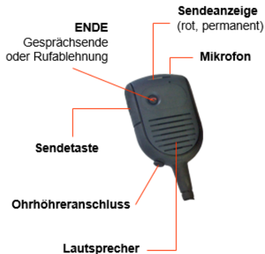
Abb. 19: Komponenten des Mikrotels
