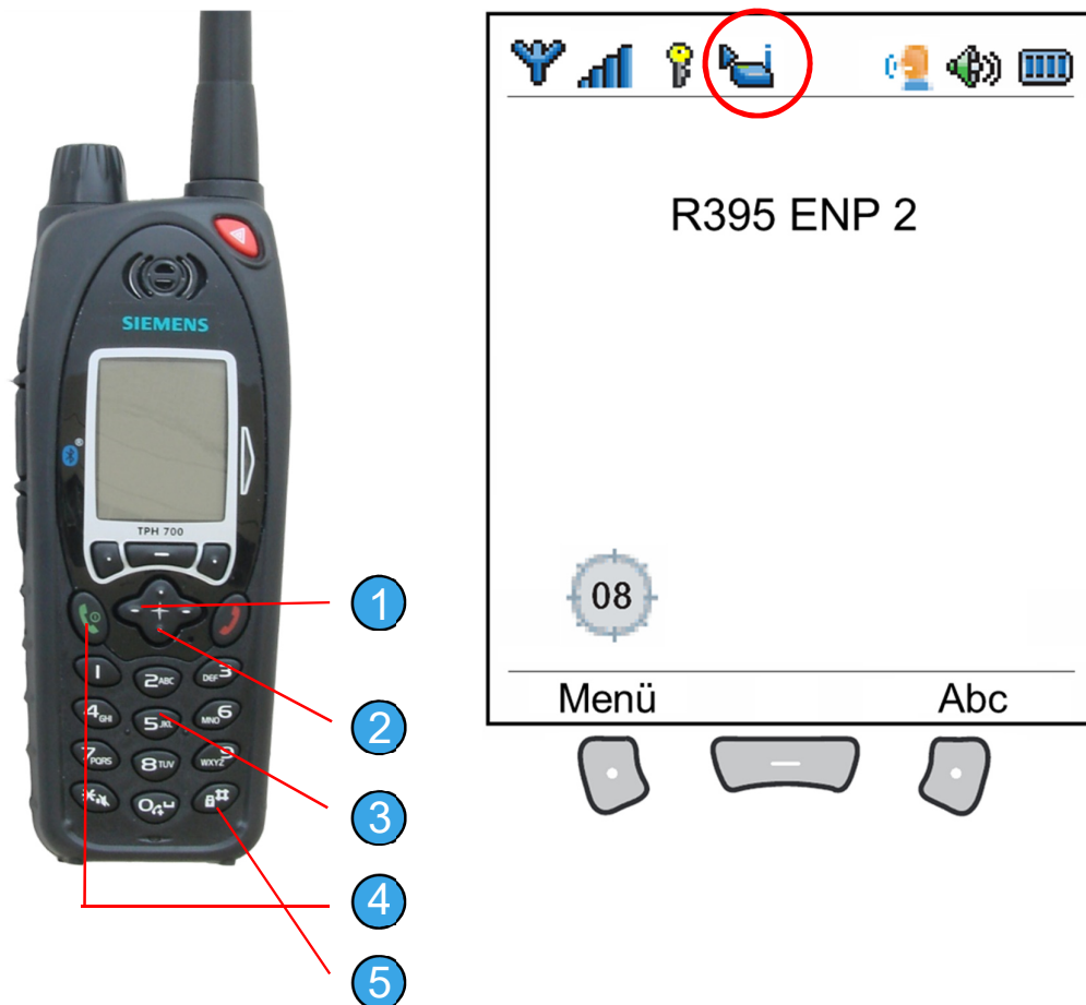
Abb. 14: Vorgehen Einstellung Relaisbetrieb
