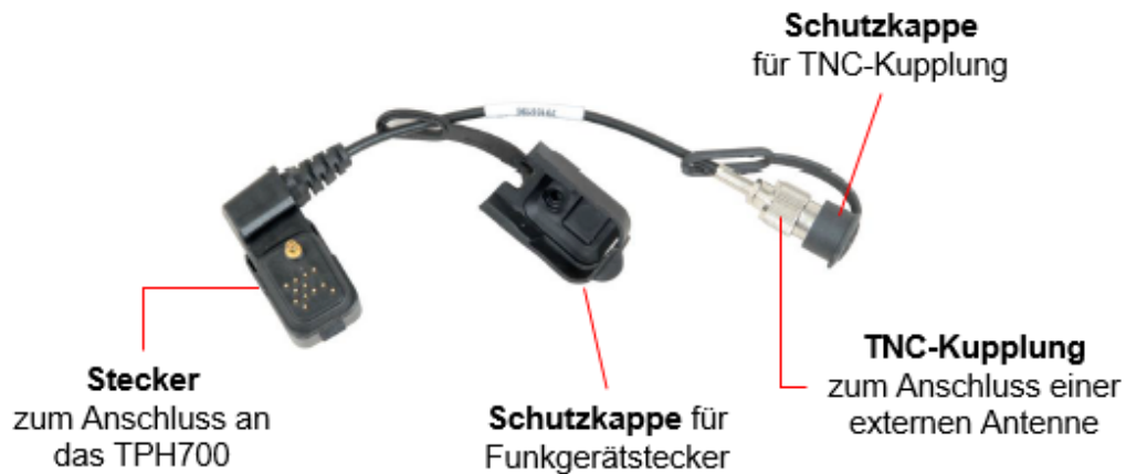
Abb. 18: Funkgerätadapter FUGA / Bestandteil des Handfunkgerätesets ZS 09
