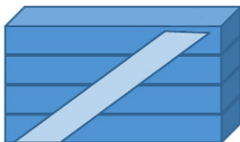
Abb.72: Aufeinandergeschichtete und mit einer Diagonalverstrebung gesicherte Kanthölzer
