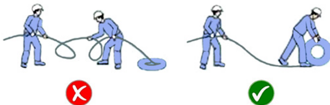
Abb. 28: Richtiges Abrollen von Drahtseilen (Kloska Group)
