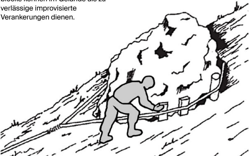
Abb.16: Verankerung an einem Felsblock (Schweizer Armee)
