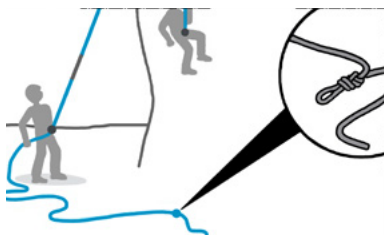
Abb. 36: Jedes Seilende muss gesichert sein (Petzl)
