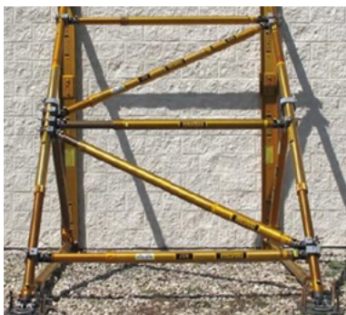
Abb.112: Stützbocke mit Systemstützen aus dem Rettungssektor (Paratech/Airshore)
