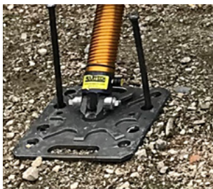
Abb. 86: Stützen mit schwenk- und drehbaren Fussplatten aus dem Bau-, Gerüstbau- und Rettungssektor
