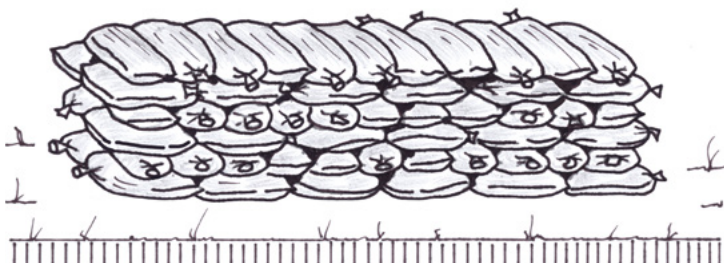
Abb. 51: Stapel versetzter Sandsäcke (Bauhandbuch der Armee)
