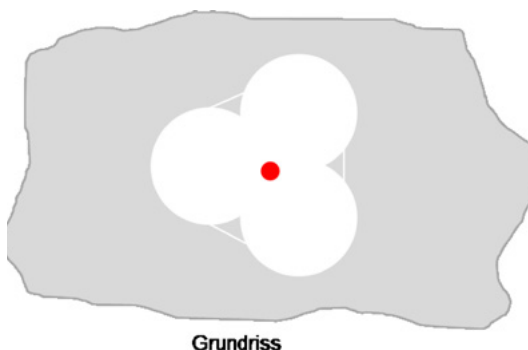
Abb. 62: Erstellen eines einfachen «Mannlochs» mit dem Kernbohrgerät
