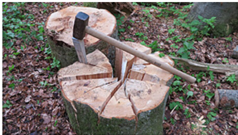
Abb.35: Holz spalten mit Spaltkeil
