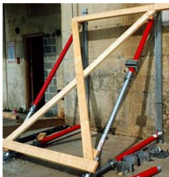
Abb.112: Stützbocke mit Systemstützen aus dem Rettungssektor (Paratech/Airshore)
