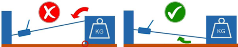
Abb. 40: Falsches und richtiges Ziehen einer Last
