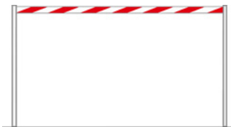
Abb. 11: Absperrung der Arbeitszone (INSARAG)
