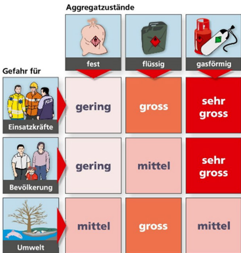
Abb.25: Gefahrenabschätzung bei Chemikalien aufgrund des Aggregatzustandes (FKS)
