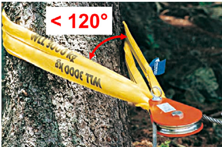
Abb. 23: Zulässiger Spreizwinkel von Verbindungsmitteln oder -elementen
