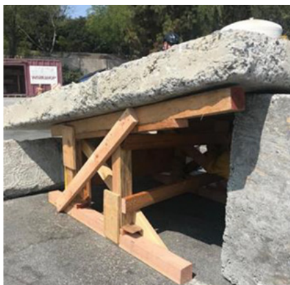
Abb.95: Schräges Raumfachwerk aus Holz (senkrechte Methode) (FEMA)
