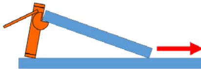
Abb. 61: Horizontale Kraft bei angewinkeltem Hebege­rät
