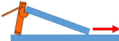
Abb. 61: Horizontale Kraft bei angewinkeltem Hebege­rät
