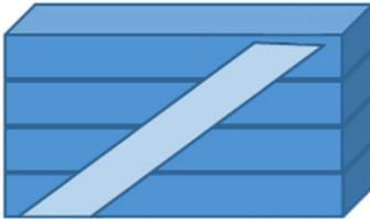
Abb.72: Aufeinandergeschichtete und mit einer Diagonalverstrebung gesicherte Kanthölzer
