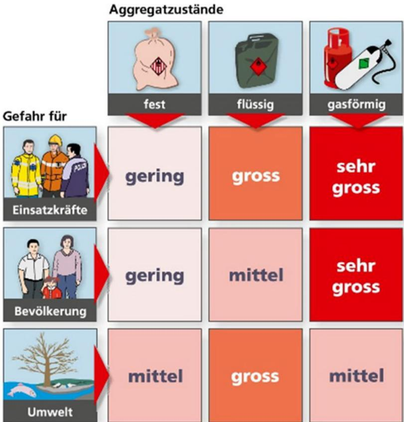
Abb.25: Gefahrenabschätzung bei Chemikalien aufgrund des Aggregatzustandes (FKS)
