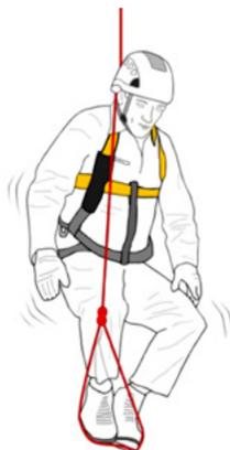
Abb.19: Entlasten der Beine mit einer Trittschlinge (Petzl)
