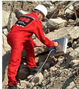
Abb. 42: Beispiel Bio-Radargerät (MEDER)
