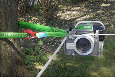
Abb. 30: Anschlagen der Winde (Eder Maschinenbau GmbH)
