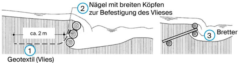
Abb. 65: Unterbindung der Sickerströmung (Geotextilien, links; Bretter, rechts)
