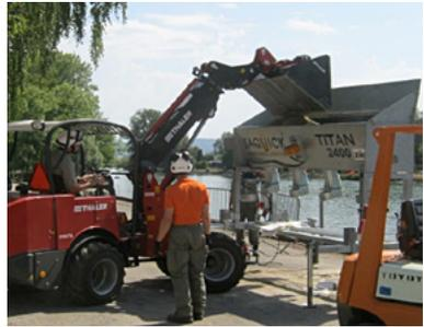
Abb.36: Abfüllmaschine mit vier Füllstationen
