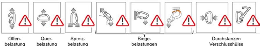
Abb.10: Fehlbelastungen bei Karabinerhaken (Petzi)
