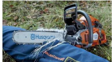
Abb. 3: Säge beim Kontakt mit Schnittschutzhose (Husqvarna)
