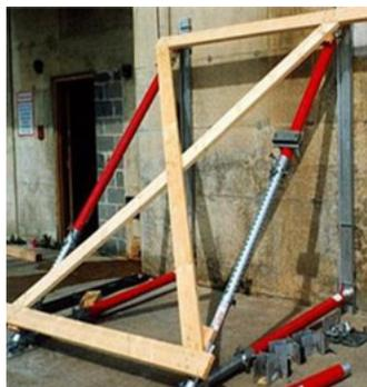
Abb.112: Stützbocke mit Systemstützen aus dem Rettungssektor (Paratech/Airshore)
