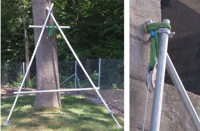
Abb. 52: Beispiele von Zweibeinen aus Gerüstrohren
