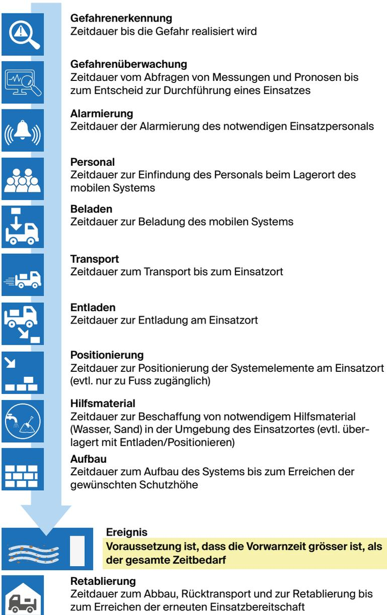
Abb. 24: Einsatzprozess Hochwasserschutz (VKF)
