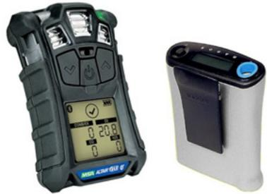
Abb. 26: Beispiel eines Mehrgaswarngerätes (links) (MSA) und eines Dosimeters (rechts)
