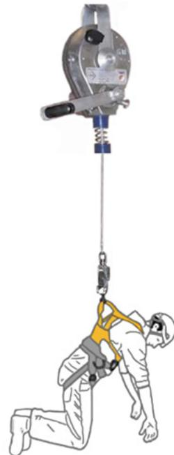
Abb.28: Rettung mit einem Höhensicherungsgerät (BABS)
