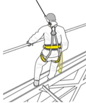
Abb. 25: Auffangsystem (Petzl)
