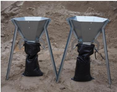
Abb.34: Fülltrichter (SAQUICK) (THW)
