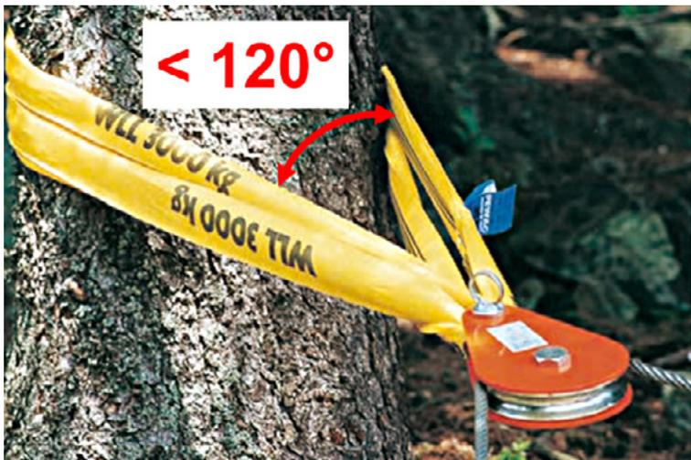
Abb. 23: Zulässiger Spreizwinkel von Verbindungsmitteln oder -elementen
