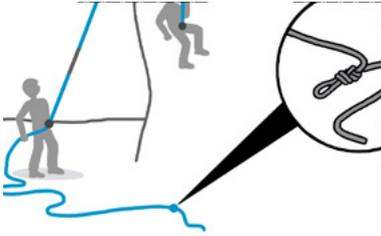
Abb. 36: Jedes Seilende muss gesichert sein (Petzl)
