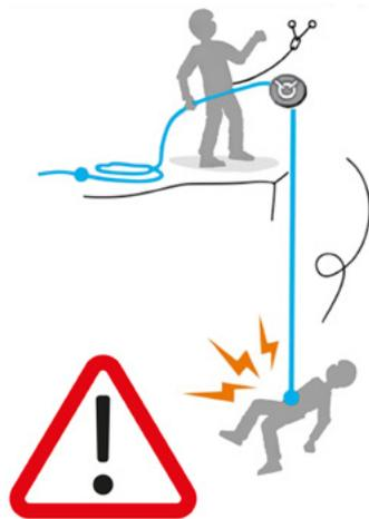
Abb. 15: Fangstoss beim Auffangen eines Sturzes (BABS)
