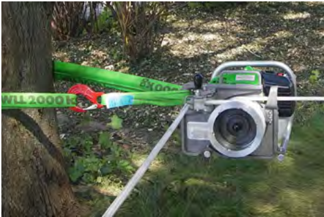
Abb. 30: Anschlagen der Winde (Eder Maschinenbau GmbH)
