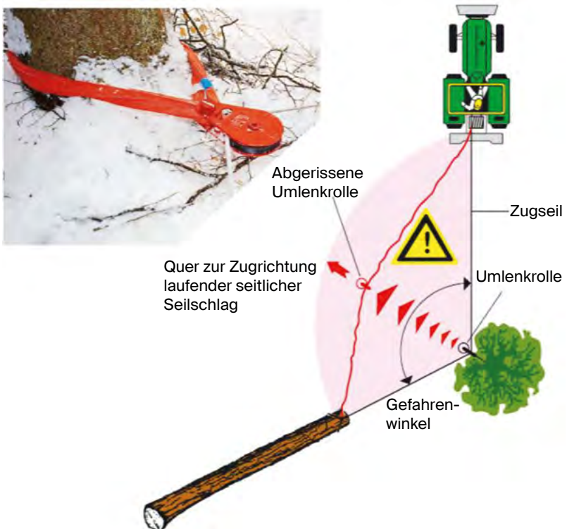
Abb.33: Gefahrenbereich im Seilwinkel
