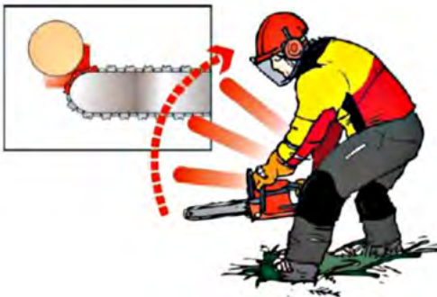
Abb. 13: Rückschlaggefahr bei der Motorsäge (Suva)
