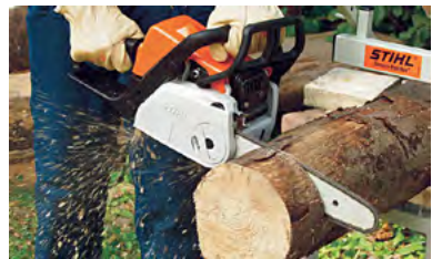
Abb. 12: Motorsäge sicher führen, korrekte Stellung der rechten Hand und Position des Daumens der linken Hand sowie der Beine (Stihl)
