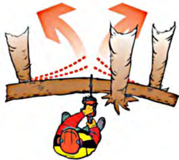
Abb. 17: Niemals in der Gefahrenzone arbeiten (Suva)
