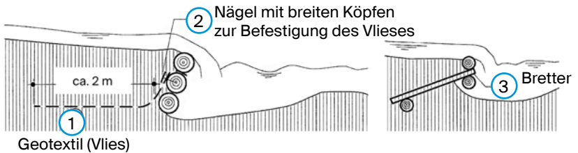
Abb. 65: Unterbindung der Sickerströmung (Geotextilien, links; Bretter, rechts)
