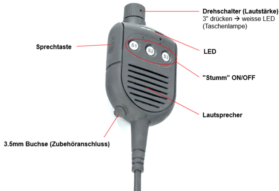
Abb. 20: Komponenten des Mikrotels HMX V.9
