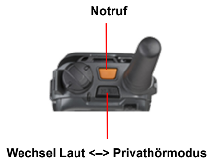
Abb. 10: Geräteaufbau TPH900 von oben
