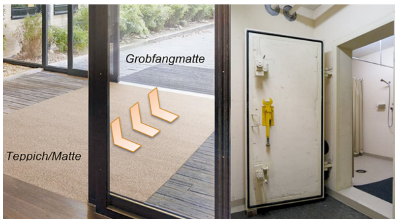
Abb. 16: Schmutzschleuse (Quelle Stilmat Suisse / Wikipedia)
