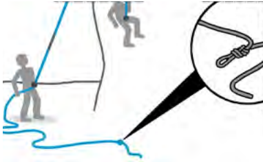
Abb. 36: Jedes Seilende muss gesichert sein (Petzl)
