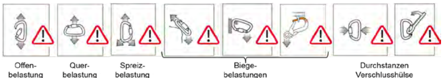
Abb.10: Fehlbelastungen bei Karabinerhaken (Petzi)
