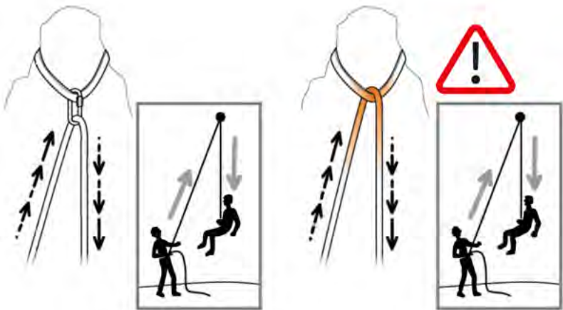
Abb.32: Schmelzverbrennung bei Seilen (Petzl)
