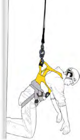
Abb. 18: Regungsloses Hängen im Auffanggurt (Petzl)
