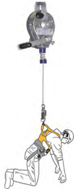
Abb.28: Rettung mit einem Höhensicherungsgerät (BABS)
