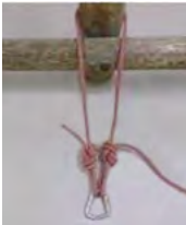
Verankerung um Mast
