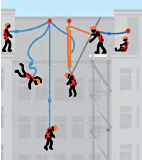
Abb.29: Improvisierte Rettung mit einer Rettungsausrüstung
