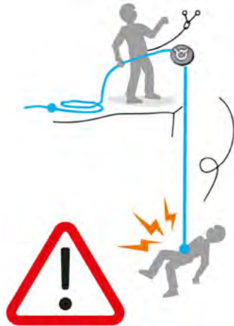
Abb. 15: Fangstoss beim Auffangen eines Sturzes (BABS)
