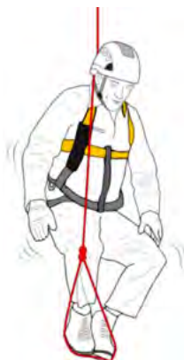
Abb.19: Entlasten der Beine mit einer Trittschlinge (Petzl)
