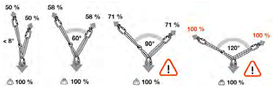
Abb. 58: Einfluss des Winkels bei Verankerungen an zwei Fixpunkten (Petzl)
