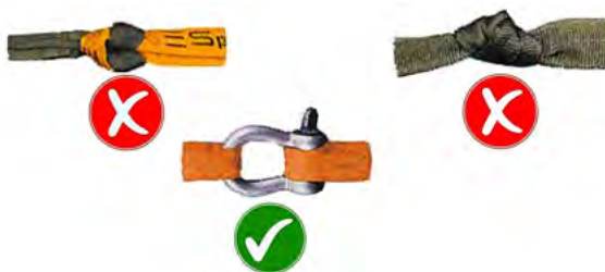
Abb. 25: Rundschlingen und Hebebänder dürfen nie geknotet, sondern müssen immer mithilfe von Schäkeln oder Lasthaken verbunden werden (Kloska Group)
