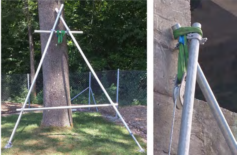
Abb. 52: Beispiele von Zweibeinen aus Gerüstrohren
