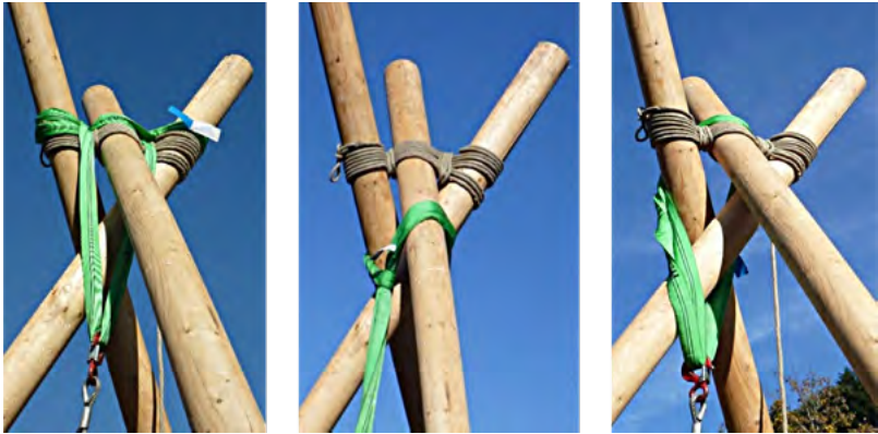
Abb. 48: Mögliche Anschlagarten von Rundschlingen am Dreibein
