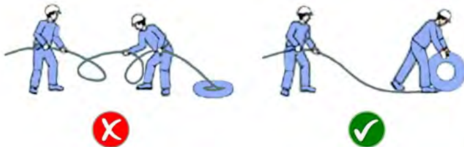
Abb. 28: Richtiges Abrollen von Drahtseilen (Kloska Group)
