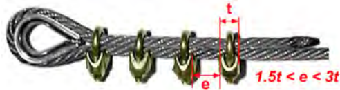
Abb.30: Formel zur Berechnung des Abstands zwischen den Klemmen (BAD Gesundheitsvorsorge und Sicherheitstechnik GmbH)
