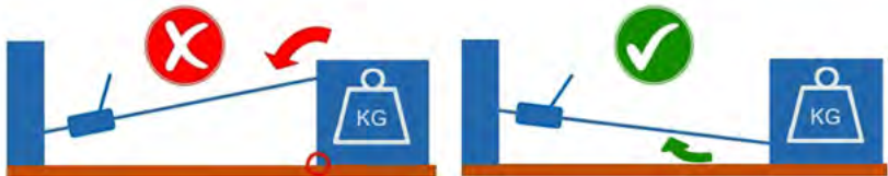
Abb.40: Falsches und richtiges Ziehen einer Last
