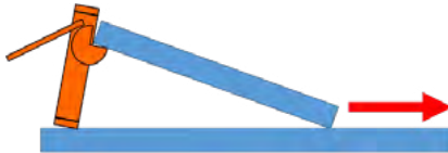
Abb. 61: Horizontale Kraft bei angewinkeltem Hebeegerät
