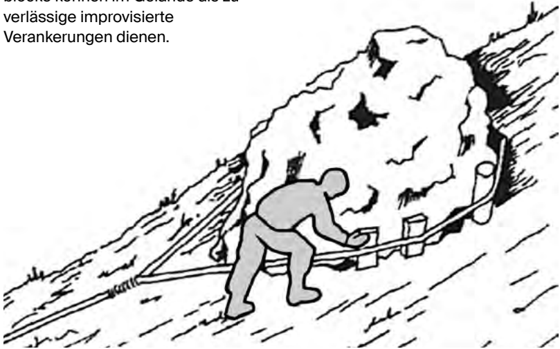
Abb. 16: Verankerung an einem Felsblock (Schweizer Armee)
