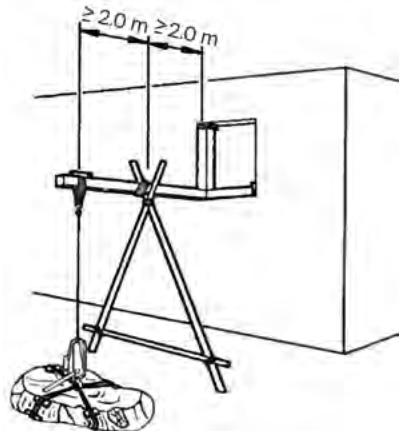
Abb. 55: Horizontaler Ausleger aus einem Gebäude mit Zweibeinabstützung
