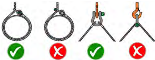
Abb.27: Richtige Anwendung von Schäkeln (Kloska Group)
