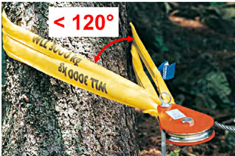
Abb.23: Zulässiger Spreizwinkel von Verbindungsmitteln oder -elementen
