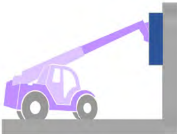
Abb.13: Abstützen mit Teleskopklader
