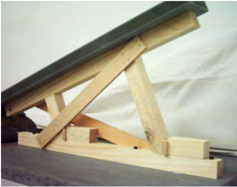
Abb. 89: Modell eines schrägen Flächenfachwerks aus Holz (rechtwinklige Methode) (Blockhaus, THW)
