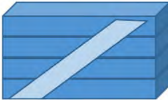
Abb. 72: Aufeinandergeschichtete und mit einer Diagonalverstrebung gesicherte Kanthölzer
