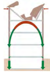
Abb. 1: Kraftableitung in die Fundamente (Wellenhofer, THW)
