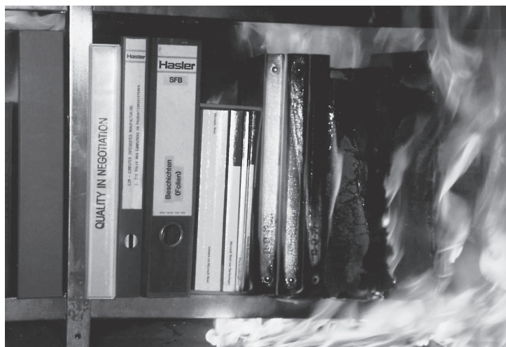
Bild unten: In einem zweiten Versuch wurde die Reaktion von modernen Medien und Kunststoffhüllen auf Feuer beobachtet.
