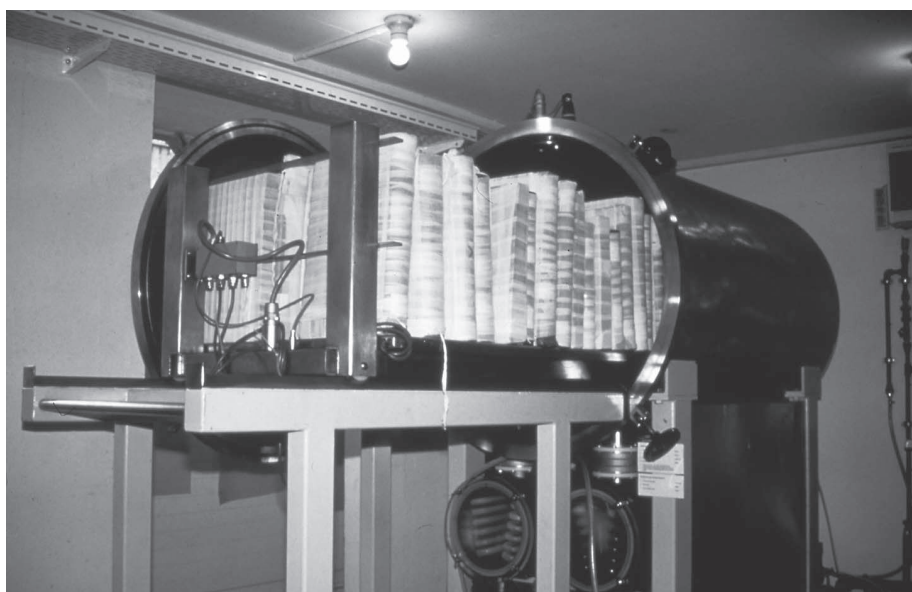
Die nassen Dokumente werden bei –22° C eingefroren und anschliessend in der Maschine (unten) gefriergetrocknet.
