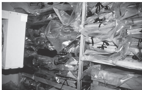
Die nassen Dokumente werden bei –22° C eingefroren und anschliessend in der Maschine (unten) gefriergetrocknet.
