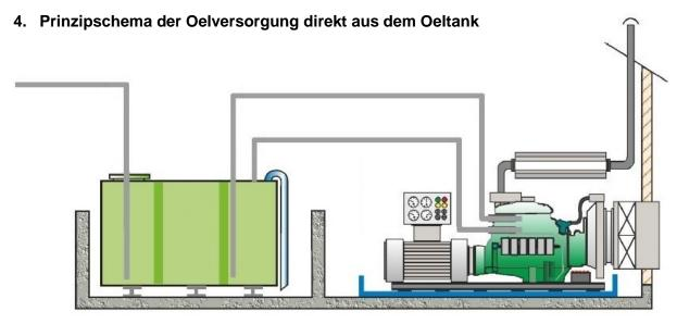
Bei direkter Oelversorgung aus dem Oeltank, entspricht der Oeltank dem Tagestank, und somit gelten für den Oeltank die Vorschriften für den Tagestank.
