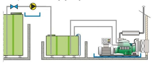
Wird der Notstrom über einen Tagestank mit Oel versorgt, ist zu beachten, dass der Tagestank mit einem Überlauf und einer Spezialfüllsicherung ausgerüstet ist. Der Tagestank (Material: **Stahl**) ist nach den Regeln der Technik des Schweizerischen Verein für technische Inspektionen (SVTI) für mittelgrosse Tanks zu dimensionieren.
