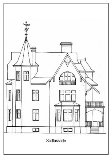
de besteht eine zweigeschossige Auslucht. An der Ostfassade im südlichen Teil liegt eine offene Veranda, deren Decke dem 1. Obergeschoss als Balkon dient. Die Fenstergewände bestehen aus Sandstein. Das Dach ist mit grauen Schieferziegeln gedeckt.
