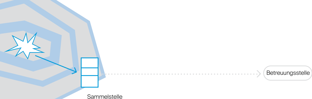
Abb. 15: Ablauf der horizontalen Evakuierung
