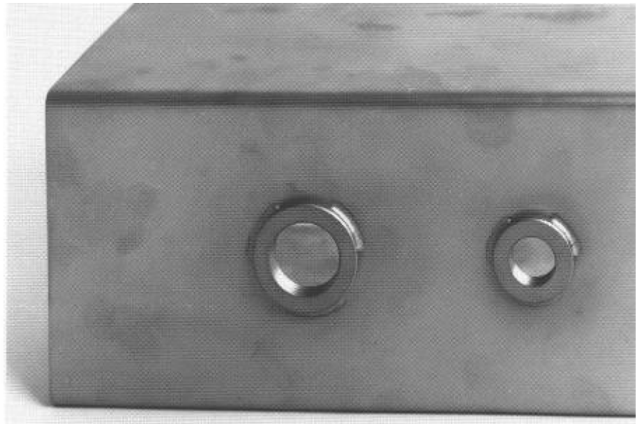
Figur 105 Schweissmutter an dünnwandigem Gehäuse
