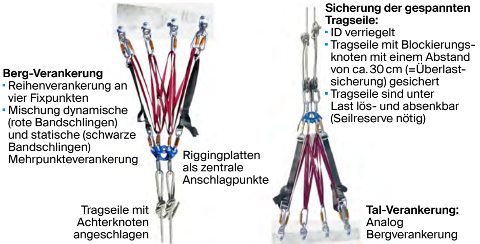
Abb. 75: Beispiel einer Berg- und Talverankerung auf Beton mit je einer Reihenverankerung an vier Fixpunkten
