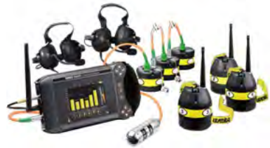
Abb. 39: Beispiel eines Horchgerätes (Leader)
