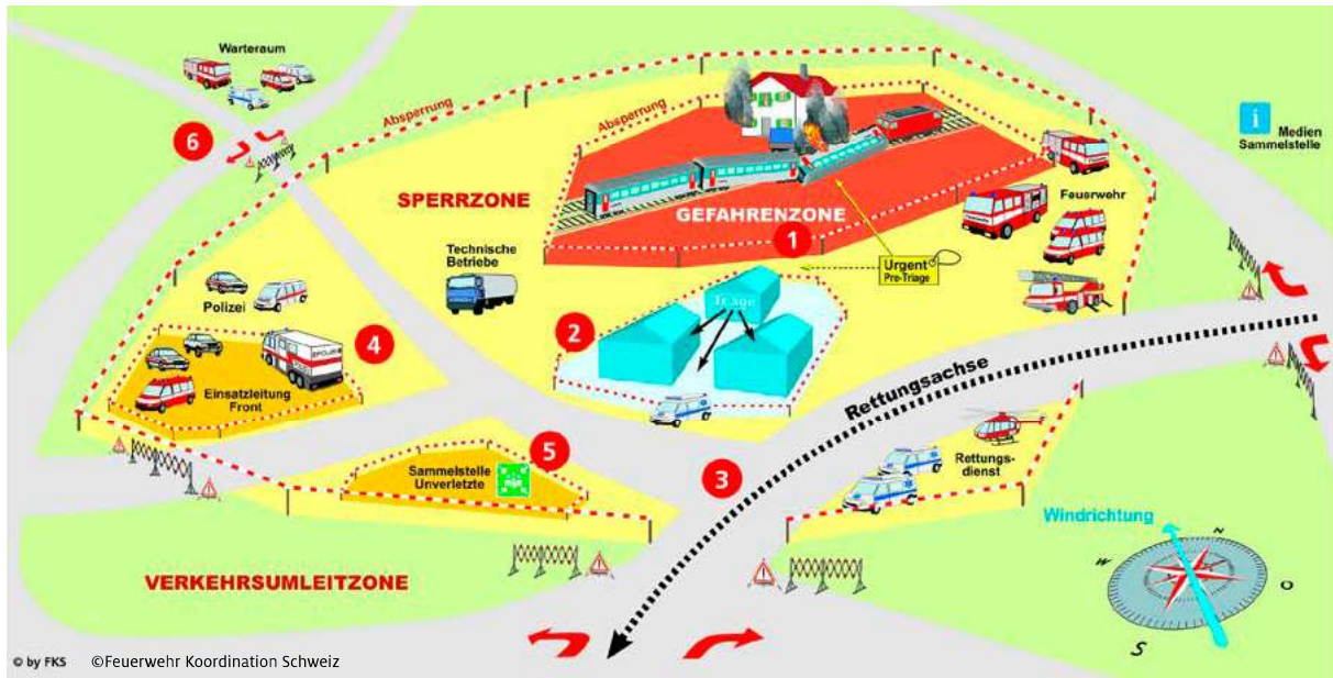
Abb. 15_2: Organisation des Schadenplatzes.
