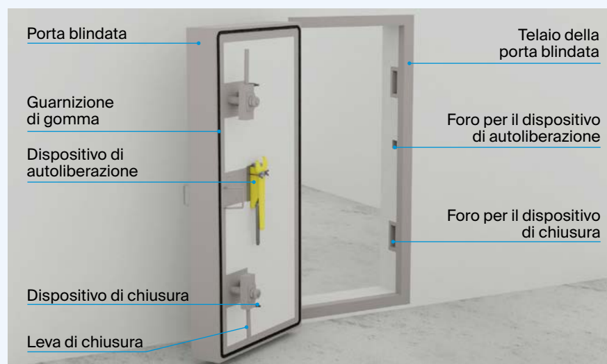
Fig. 4a/4b Durante la preparazione del rifugio si deve controllare che tutti i componenti siano presenti e funzionanti. La porta blindata permette di accedere al rifugio, ma deve anche assolvere una funzione protettiva. Prima di occupare il rifugio, bisogna smontare le porte normali.
