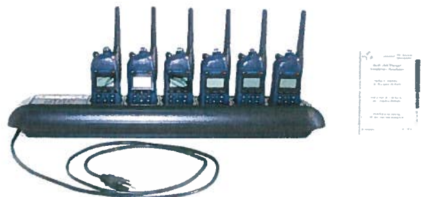
Figura 6 - caricatore multiplo con sei posti di ricarica e istruzioni per l'installazione d, f, i
