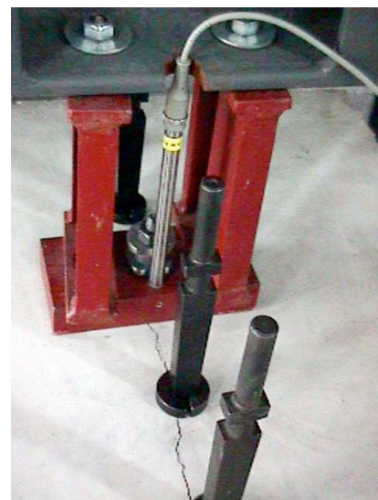
Bild 4 Im gerissenen Prüfkörper (Rissweite 1mm) versetzter Dübel
