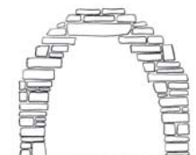
Kraggewölbe (falsches Gewölbe)
