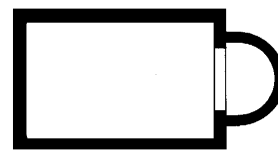
Saalkirche mit Apsis (Einschiffiger Längsbau)
