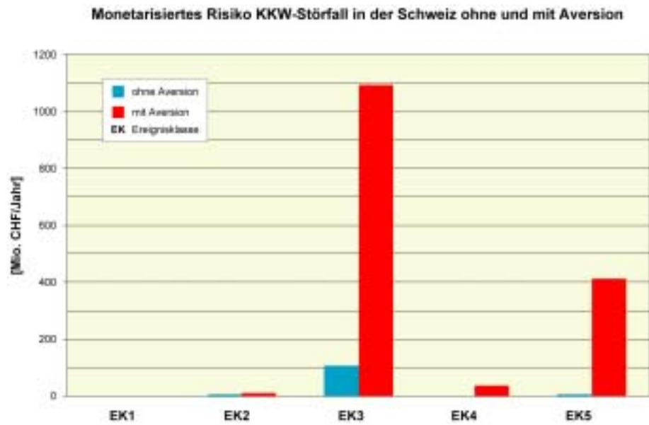
Abbildung 27: Einfluss der berücksichtigten Aversion auf die Risiken durch KKW-Störfall in der Schweiz
